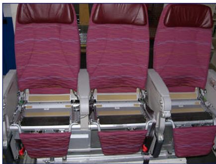
Ticona-Sitzgruppen werden leichter durch Faserverbundwerkstoff Tepex
