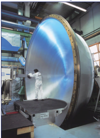
Für die Ariane 5 Haupttanks wurde ein neuartiger Tankdom mit 5,4 m Durchmesser im Spinforming-Verfahren gefertigt. Die Anwendung dieser Fertigungstechnologie führt zu deutlichen Kostenreduzierungen im Herstellungsprozess.
