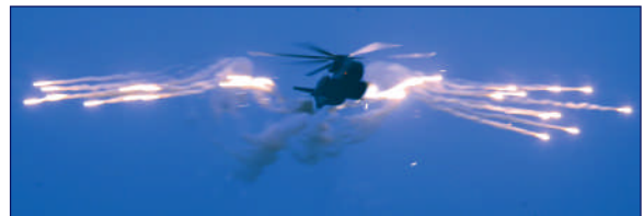
Hubschrauber vom Typ CH-53GS mit MILDS-Flugkörper-Warnsystem
