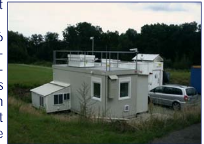
Lidarstation RAMSES am Observatorium Lindenberg des Deutschen Wetterdienstes DWD
